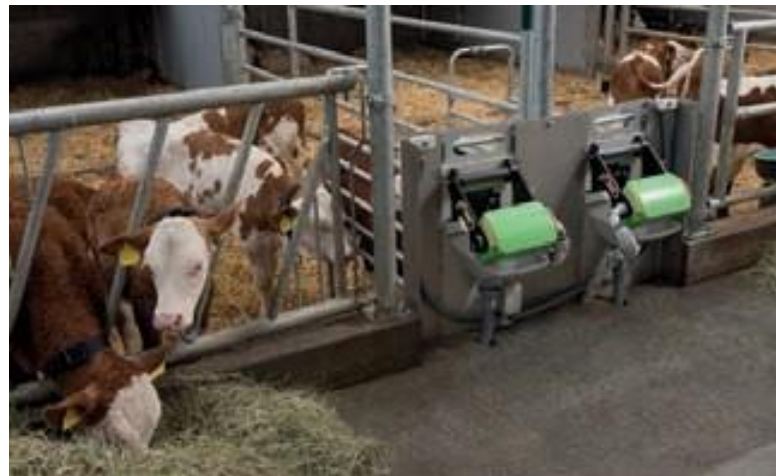
Voeren aan CalfRail en groepen met slechts één voerautomaat
